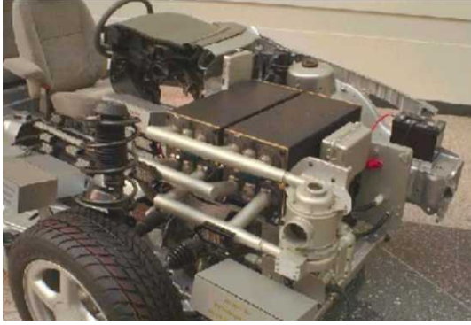
Resim 3.2. Ticari araç için geliştirilmiş yakıt pili sistemi ve araca uygulanması [8]
