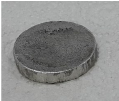
Resim 5.9. Sıcak presleme yöntemi ile elde edilen numune
