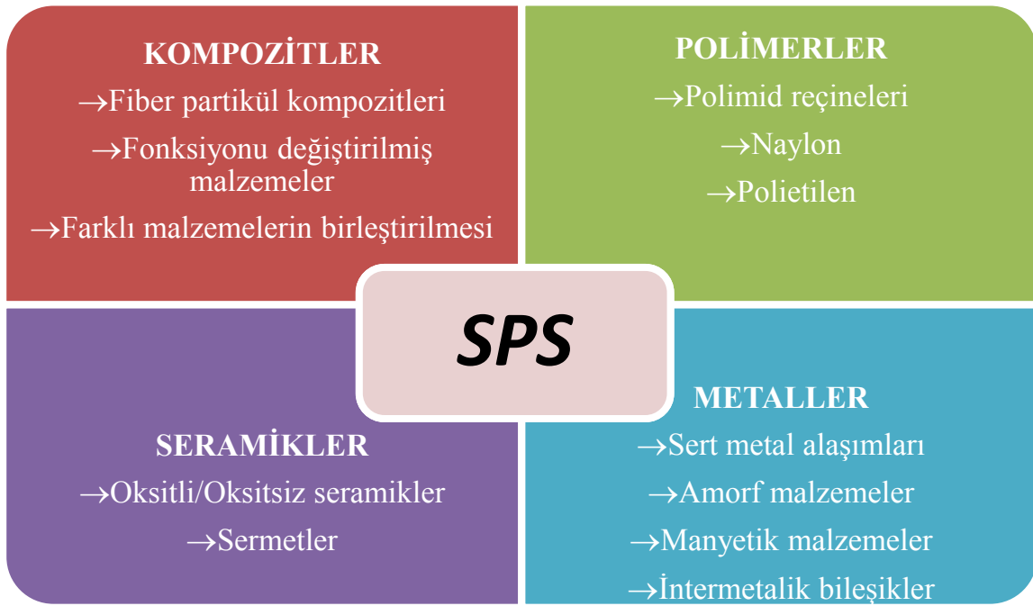
Şekil 2.13. SPS yöntemiyle üretilebilen malzeme türleri
