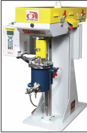
Resim 3.1. Atritör tipi değirmen ve kesit görünüşü a) Union Process Marka HD01/HDDM-01 Model Attritor, b) Atritör tipi yatay değirmenin kesit görünüşü
