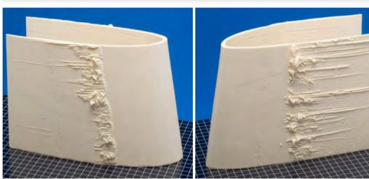
Şekil 3.10. Kanadın alt ve üst yüzeyinde yeniden buzlanma birikimi [29]
