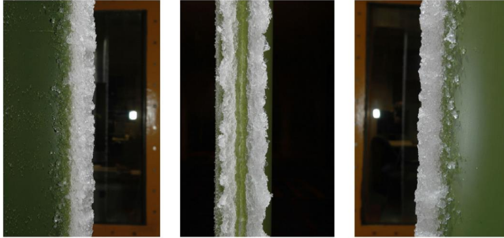
Şekil 3.3. Bir kanadın basınç yüzeyi, ön kenarı ve emme yüzeyi üzerindeki camsı buzlanma sonucu oluşan boynuz tipi buzlanma [25]
