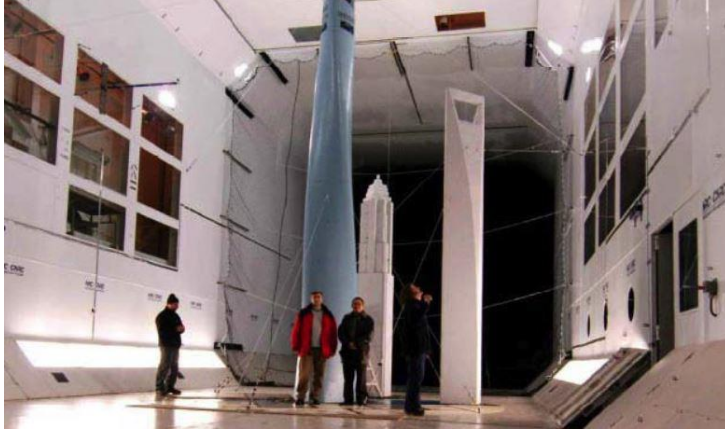
Resim 4.10. 1:85 Reynold rüzgar tüneli çalışması [141]
