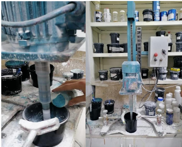
Resim 7.2. Bakır floroboratın boya içerisinde karıştırılması sonucu sertleşmesi
