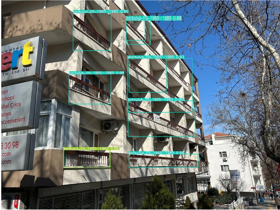
Şekil 5.28. Algoritmada test edilen Cinnah'ta apartman binası çıktısı
