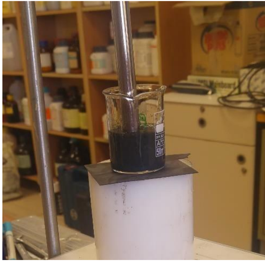
Resim 3.2. Elektrot hamurunun ultrasonik homojenizatör yardımıyla karıştırılması (solda) ve Süperkapasitör elektrot sistemi (sağda)
