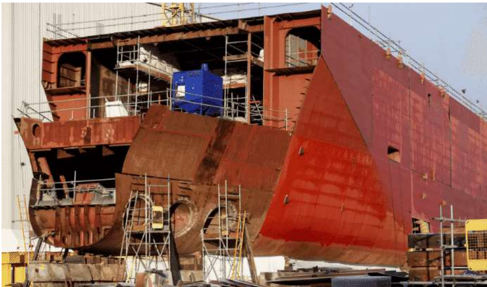
Resim 3.4. Blokların kızakta birleşimi (İnternet: MEGEP, 2016)
