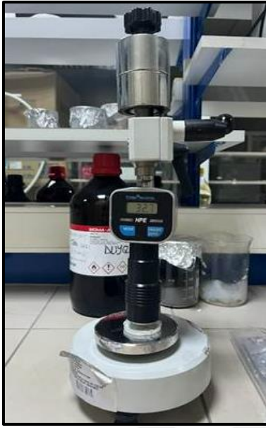
Resim 4.2. Bareiss marka shore-d sertlik ölçüm cihazı
