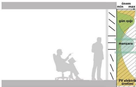
Şekil 3.4. Giydirme cephe fotovoltaik sistem tasarım yaklaşımı (Kızıлтаş, 2019)
