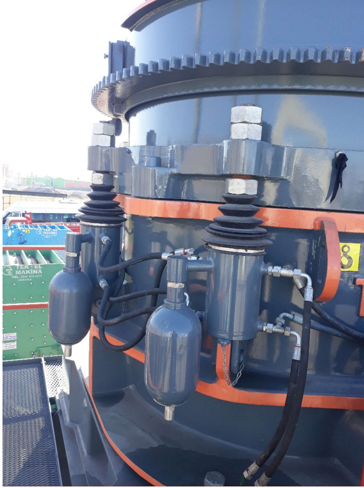
Resim 6.1. TKL3000SE konik kırıcı hidrolik silindirleri ve akümülatörleri
