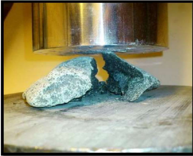
Resim 4.1. Sıkıştırma kırılmasına maruz kalan bir amfibolit parçası [9]
