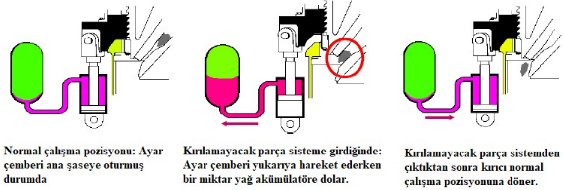
Şekil 3.12. Kırılacak parçanın sistemden atılması
