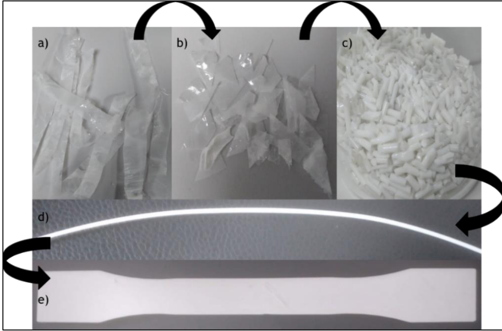
Resim 3.1. PLA/h-BN üretim aşamaları: a) Homojen karıştırılıp kurutulan formu; b) Ekstrüder için küçültülmüş form; c) Granül form; d) PLA/h-BN filament; e) 3d yazıcı formu.
