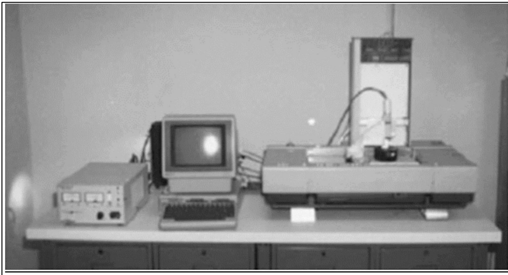
Şekil 2.1. 3D Systems tarafından üretilen stereolitografi cihazı (Gibson vd. 2014)
