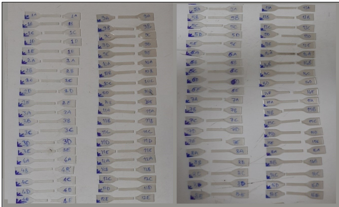
Şekil 5.22. Çekme testi sonrasında numuneler
