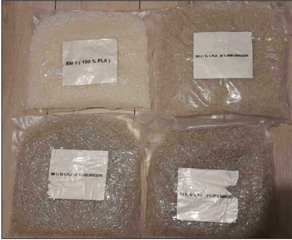
Şekil 5.7. Filament üretimi sonrası artan plastik granüllerin vakumlanması
