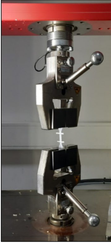
Şekil 5.19. Numunelerin çenelere sabitlenmesi
