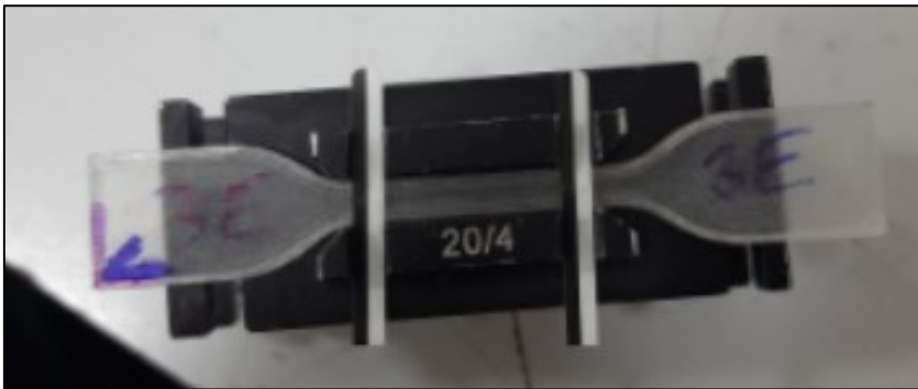
Şekil 5.18. Numunelerin fikstür üzerine yerleştirilmesi
