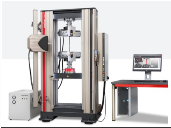
Şekil 5.16. Zwick Roell Z005 test cihazı ( www.zwickroell.com )
