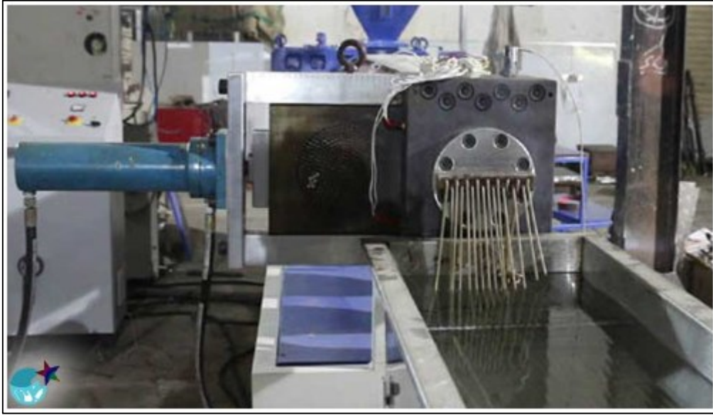
Şekil 4.4. Ekstrüzyon işleminde kullanılan soğutma sistemi ( www.turkiyeplastik.com )
