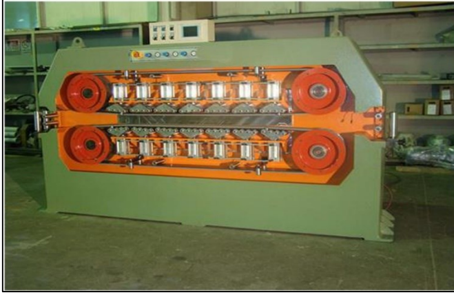
Şekil 4.5. Ekstrüzyon metodunda kullanılan bir çekici (MEB 2011)
