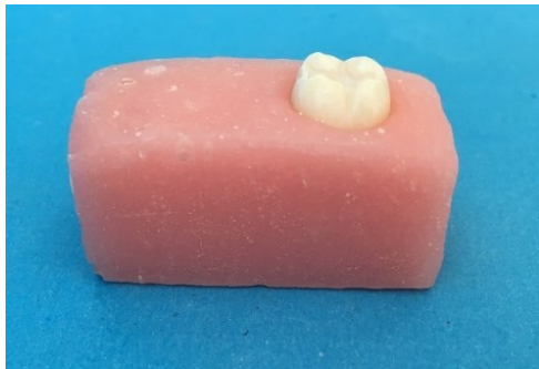
Resim 3.17. Mikrosızıntı testi öncesi akrilik bloklara gömülen örnek bir dişin görüntüsü
