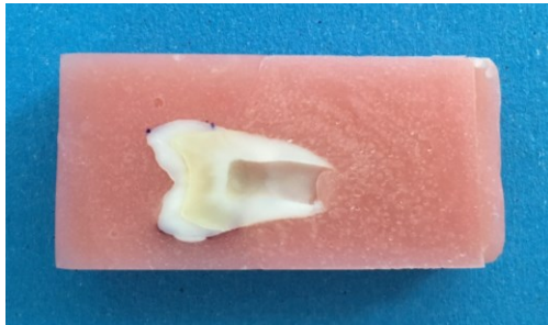
Resim 3.25. Mikrosertlik ölçümü için hazırlanan örnek bir dişin görüntüsü
