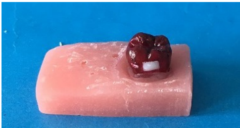
Resim 3.23. Mikrosertlik testi için akril bloktaki örnek bir dişin görüntüsü
