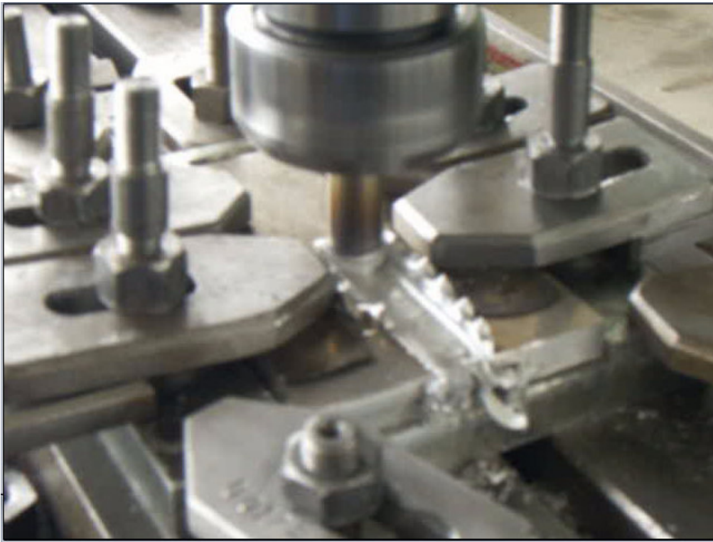
Resim 5.6. Sürtünme kaynağı işleminin başlangıç aşaması
