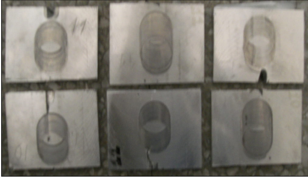
Resim 5.26. Isıl işleme sonrası haddeleme uygulanmış numuneler
