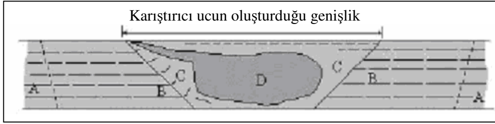
Şekil 3.6. Sürtünme karıştırma kaynağında kaynak bölgesinde oluşan iç yapının Şematik Görünümü. B: ısının tesiri altındaki bölge (ITAB), C: termodinamik olarak yeniden kristalleşen bölge (TEB), D: dinamik olarak yeniden kristalleşen bölge (DKB), A:kaynak tesiri altında olmayan bölge [36].
