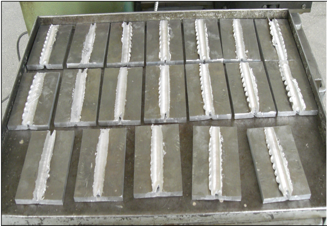
Resim 5.12. Sürtünme karıştırma kaynağı yapılan parçalar
