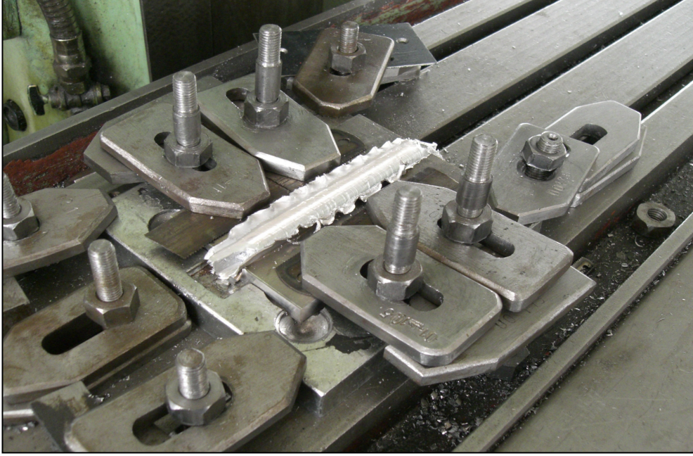
Resim 5.8. Sürtünme kaynağı yapılmış olan malzemenin kalıba ve tezgaha bağlanmış hali
