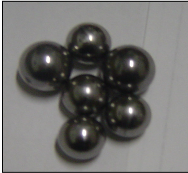
Resim 5.14.Haddeleme aparatı ucunda kullanılan bilyeler
