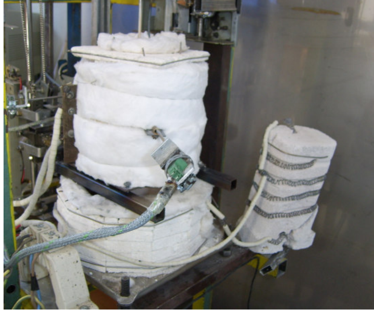
Resim 7.3. Yönlü katılaştırma düzeneğinde kullanılan fırın ve fırın yalıtımı
