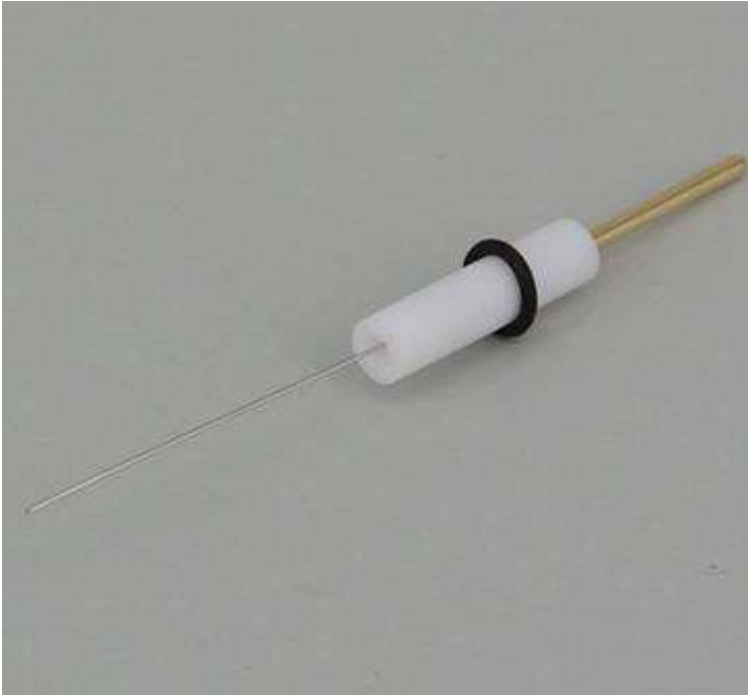
Resim 3.2. Karşıt elektrot (platin tel)
