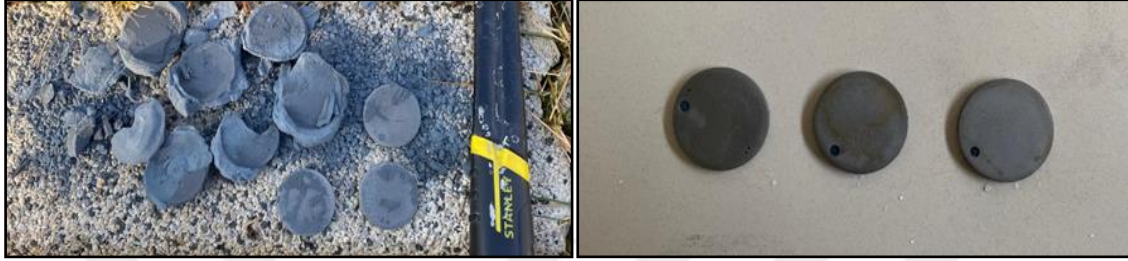
Resim 4.9. Borlama sonrası çıkan numune ve ultrasonik ile temizlenmiş numune
