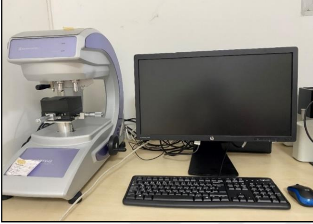
Resim 4.14. Shimadzu HMV-G mikro sertlik ölçüm cihazı
