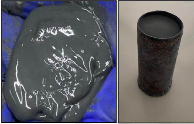
Resim 4.7. Üzeri macunlanmış ve toz içerisine gömülmüş numuneler içeren kap
