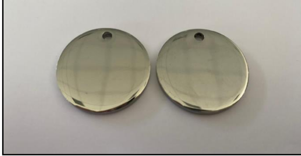
Resim 4.5. Ayna görünümü sağlanmış çelikler
