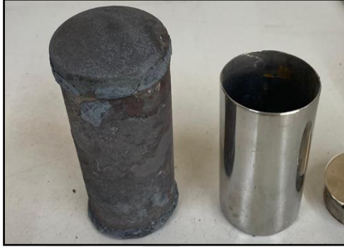
Resim 4.2. Kullanılmış paslanmaz çelik borlama kabı ve kullanılmamış paslanmaz çelik borlama kabı (Pota-Retort)
