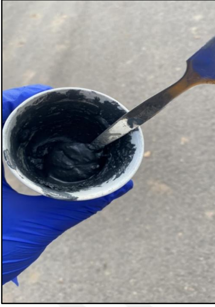
Resim 2.1. İşlem öncesi hazırlanmış borlama macunu
