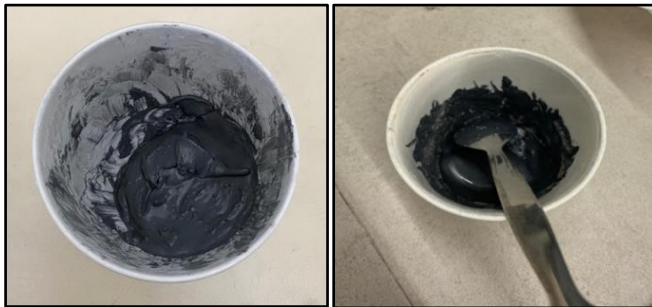
Resim 4.6. Borlama işlemi için hazırlanmış macun örnekleri
