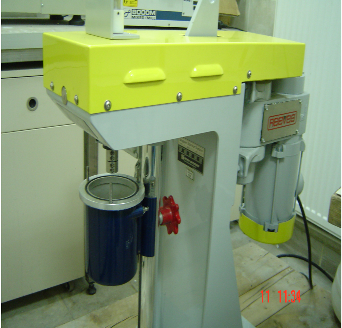
Resim 4.1. Alaşım tozlarının hazırlanmasında kullanılan mekanik alaşımlama /karıştırma cihazı
