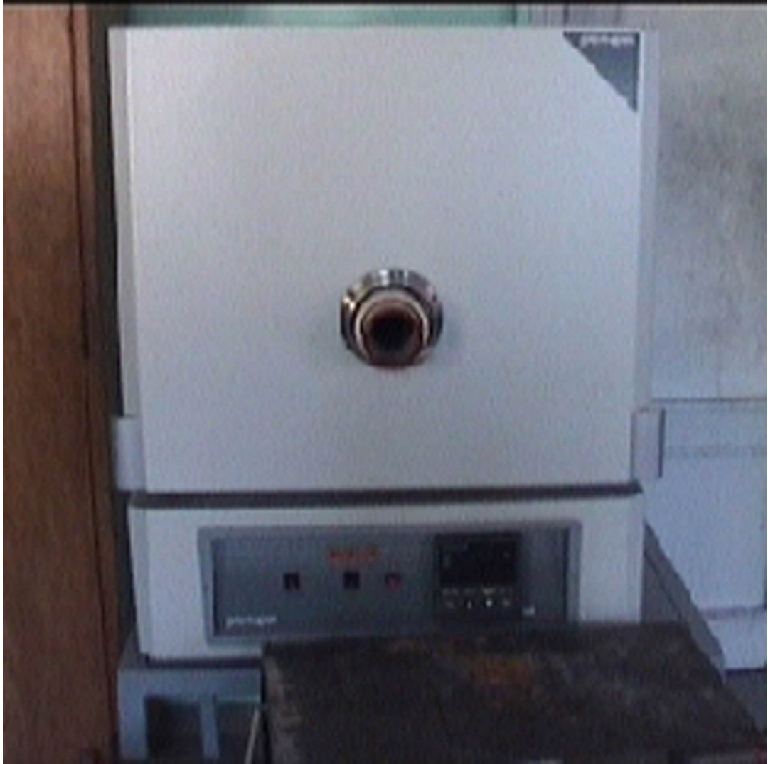
Resim 4.2. Sinterleme ve tane büyütmeye işlemlerinin yapıldığı çok amaçlı 1600 °C ısıtma kapasiteli fırın
