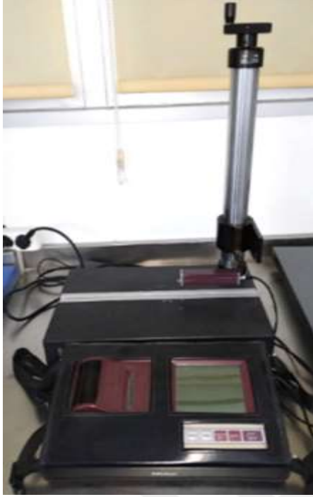
Resim 3.17. Profilometre cihazı (Surfest SJ-301) resmi
