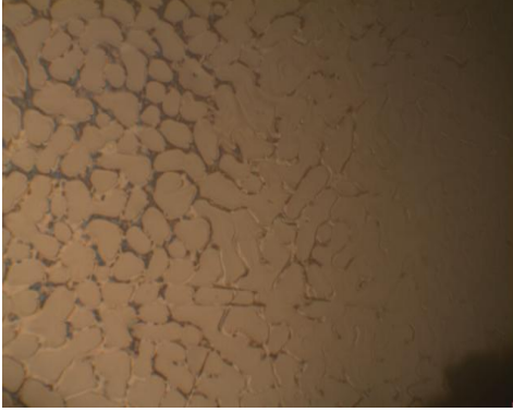
Resim 8.1. (Devam) DT 11 katkılı ZLI-1132 sıvı kristaline ait farklı sıcaklıklardaki tekstürler
