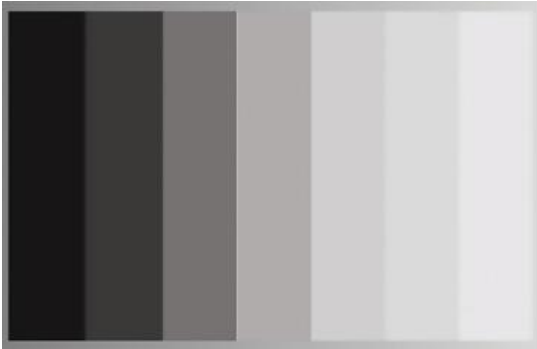
Şekil 2.2. Kademeli derecelendirilmiş bir mikroyapının şematik gösterimi
