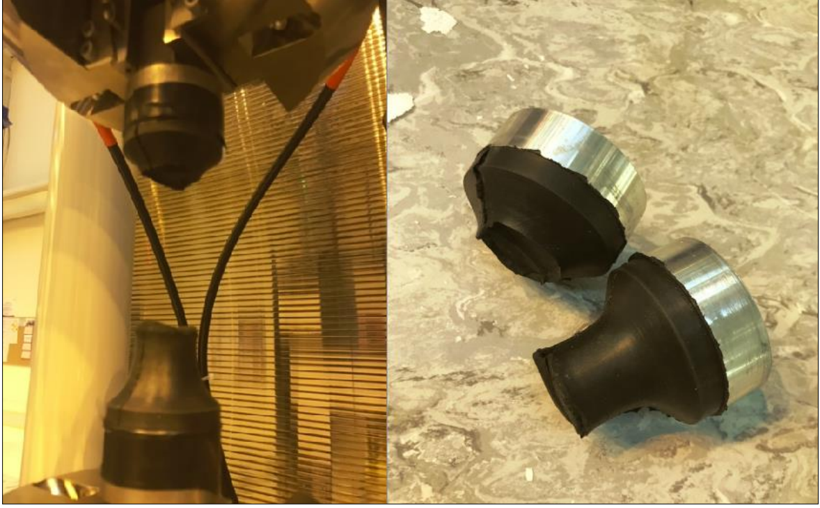
Resim E2.3. Test numunesi yarıçap değişim bölgesinde kopma oluşumu
