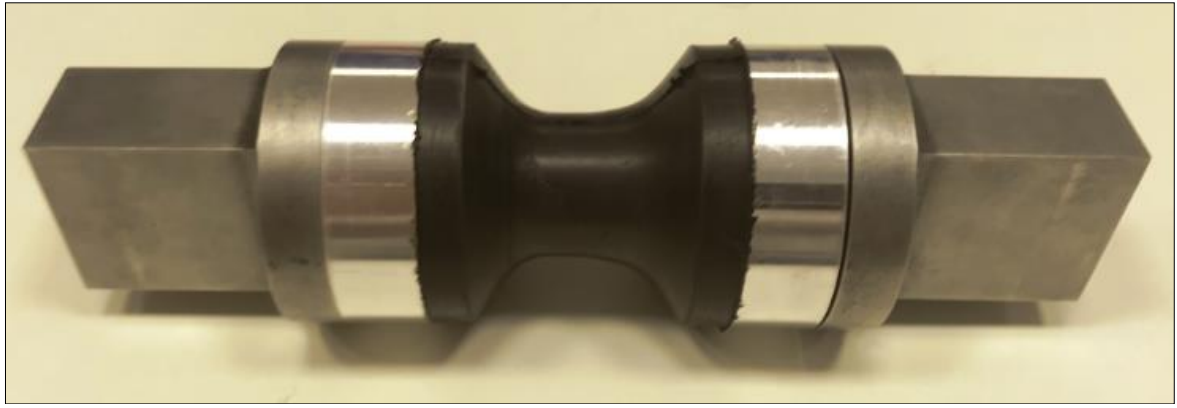
Resim 4.2. Diabolo test numunesi, metalik plakalar, ara yüzler ve saplama montajı
