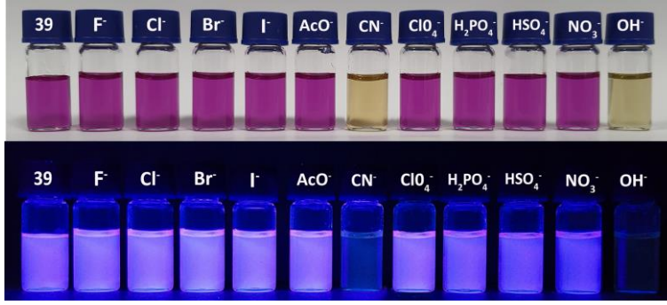
Resim 7.10. 39 (40 \mu\text{M} ) bileşiğinin anyonlarla etkileştikten sonra gün ışığındaki (üst) ve UV lambası (alt) ( \lambda_{\text{ex.}}=365 \text{ nm} )altındaki fotoğrafları
