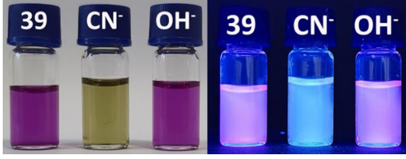
Resim 7.38. 39 bileşiği DMSO:Su (7:3, v/v) içerisinde 30 eşdeğer mol anyon eklendikten sonra gün ışığındaki (sol) ve UV lambası altındaki ( \lambda_{ex.}=365 nm) (sağ) fotoğrafları
