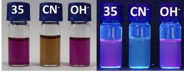
Resim 7.34. 35 bileşiği DMSO:Su (7:3, v/v) içerisinde 30 eşdeğer mol anyon eklendikten sonra gün ışığındaki (sol) ve UV lambası altındaki ( \lambda_{ex.}=365 nm) (sağ) fotoğrafları
