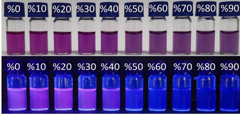
Resim 7.32. 38 bileşiği farklı oranlarda DMSO:Su karışımı içerisindeki ortam ışığı (üst) UV ışığı (365nm, alt ) altındaki fotoğrafları. Su oranları üst tarafta soldan sağa doğru artarak verilmiştir
