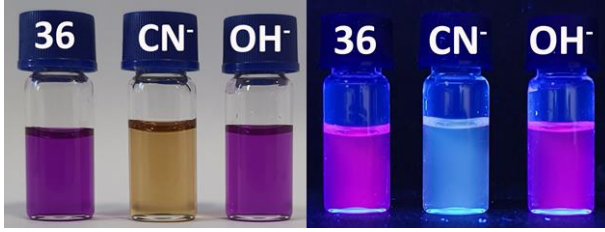
Resim 7.35. 36 bileşiği DMSO:Su (8:2, v/v) içerisinde 30 eşdeğer mol anyon eklendikten sonra gün ışığındaki (sol) ve UV lambası altındaki ( \lambda_{ex.}=365 nm) (sağ) fotoğrafları
