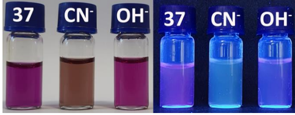
Resim 7.41. 37 bileşiği DMSO:Çeşme Suyu (1:1, v/v) içerisinde 30 eşdeğer mol anyon eklendikten sonra gün ışığındaki (sol) ve UV lambası altındaki ( \lambda_{ex.}=365 nm) (sağ) fotoğrafları
