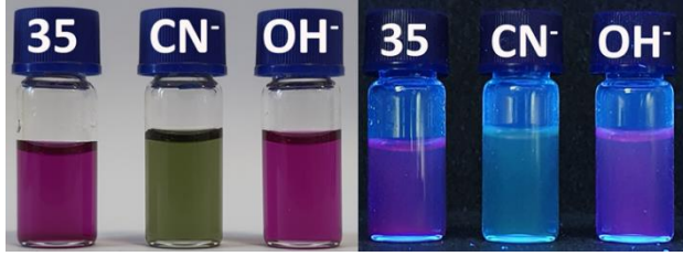
Resim 7.39. 35 bileşiği DMSO:Çeşme Suyu (7:3, v/v) içerisinde 30 eşdeğer mol anyon eklendikten sonra gün ışığındaki (sol) ve UV lambası altındaki ( \lambda_{ex.}=365 nm) (sağ) fotoğrafları
