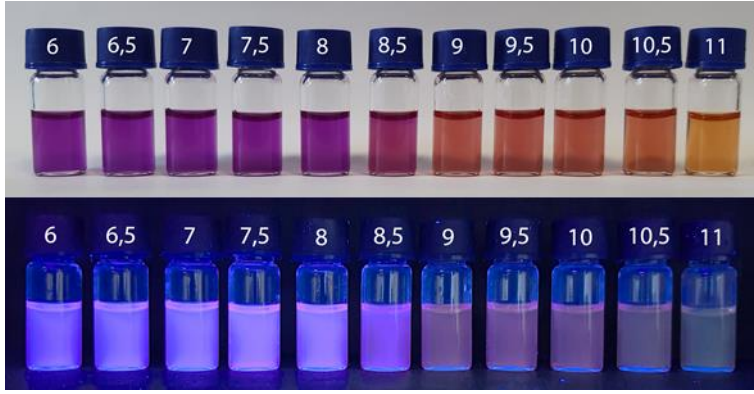
Resim 7.48. 39 bileşiği DMSO:Britton Robinson tamponu (7:3, v/v) içerisindeki farklı pH değerlerindeki gün ışığındaki (üst) ve UV lambası altındaki ( \lambda_{ex}=365 nm) (alt) fotoğrafları. pH soldan sağa doğru artmaktadır
