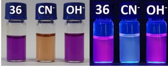
Resim 7.40. 36 bileşiği DMSO:Çeşme Suyu (8:2, v/v) içerisinde 30 eşdeğer mol anyon eklendikten sonra gün ışığındaki (sol) ve UV lambası altındaki ( \lambda_{ex.}=365 nm) (sağ) fotoğrafları
