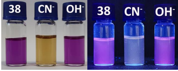
Resim 7.37. 38 bileşiği DMSO:Su (7:3, v/v) içerisinde 30 eşdeğer mol anyon eklendikten sonra gün ışığındaki (sol) ve UV lambası altındaki ( \lambda_{ex.}=365 nm) (sağ) fotoğrafları
