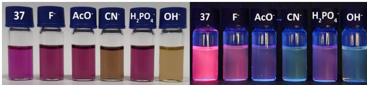
Resim 7.13. 37 (20 \mu\text{M} ) bileşiğinin anyonlarla etkileştikten sonra gün ışığındaki (sol) ve UV lambası (sağ) ( \lambda_{\text{ex.}}=365 \text{ nm} ) altındaki fotoğrafları
