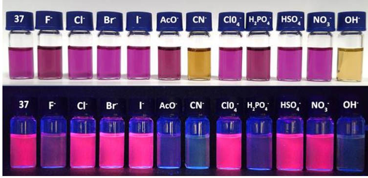
Resim 7.8. 37 (40 µM) bileşiğinin anyonlarla etkileştikten sonra gün ışığındaki (üst) ve UV lambası (alt) ( \lambda_{ex.}=365 nm) altındaki fotoğrafları
