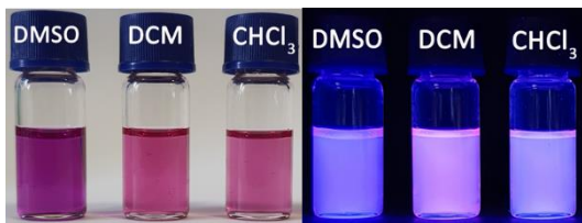
Resim 7.5. 39 (20 \mu\text{M} ) bileşiğinin farklı çözücüler içindeki gün ışığında (sol) ve UV ışığı (365 nm) altında (sağ) alınan fotoğrafları
