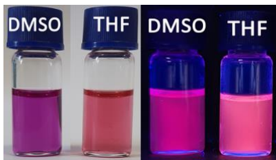
Resim 7.3. 37 (40 \mu M) bileşiğinin farklı çözücüler içindeki gün ışığında (sol) ve UV ışığı (365 nm) altında (sağ) alınan fotoğrafları
