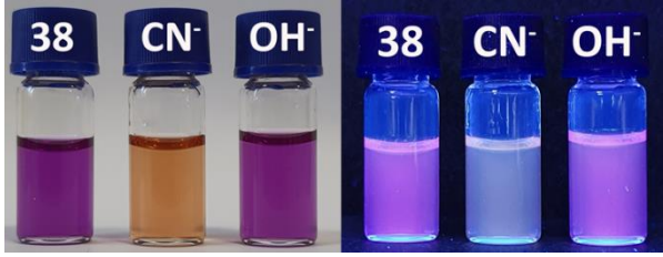
Resim 7.42. 38 bileşiği DMSO:Çeşme Suyu (7:3, v/v) içerisinde 30 eşdeğer mol anyon eklendikten sonra gün ışığındaki (sol) ve UV lambası altındaki ( \lambda_{ex.}=365 nm) (sağ) fotoğrafları
