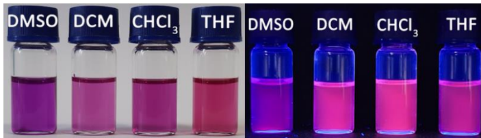
Resim 7.2. 36 (40 \mu\text{M} ) bileşiğinin farklı çözücüler içindeki gün ışığında (sol) ve UV ışığı (365 nm) altında (sağ) alınan fotoğrafları
