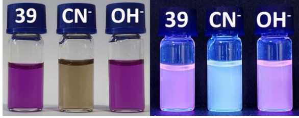
Resim 7.43. 39 bileşiği DMSO:Çeşme Suyu (7:3, v/v) içerisinde 30 eşdeğer mol anyon eklendikten sonra gün ışığındaki (sol) ve UV lambası altındaki ( \lambda_{ex.}=365 nm) (sağ) fotoğrafları
