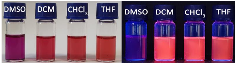
Resim 7.1. 35 (40 \mu M) bileşiğinin farklı çözücüler içindeki gün ışığında (sol) ve UV ışığı (365 nm) altında (sağ) alınan fotoğrafları
