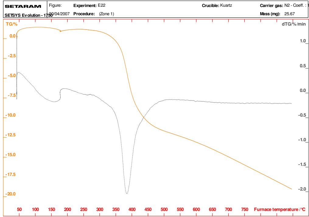
Şekil 5.10. E2 45 numune grubunun TGA ve türev termogramı
