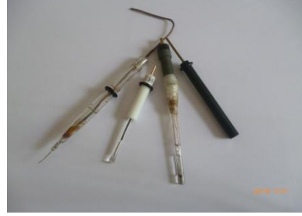
Resim 3.3. Karşıt elektrot, referans elektrot, CHI 102 platin disk elektrot, CHI 108 25 \mu\text{m} Pt ultra mikro disk elektrot (Soldan sağa doğru sırasıyla)
