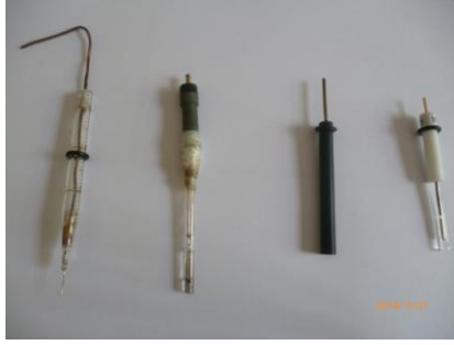
Resim 3.3. Karşıt elektrot, referans elektrot, CHI 102 platin disk elektrot, CHI 108 25 \mu\text{m} Pt ultra mikro disk elektrot (Soldan sağa doğru sırasıyla)
