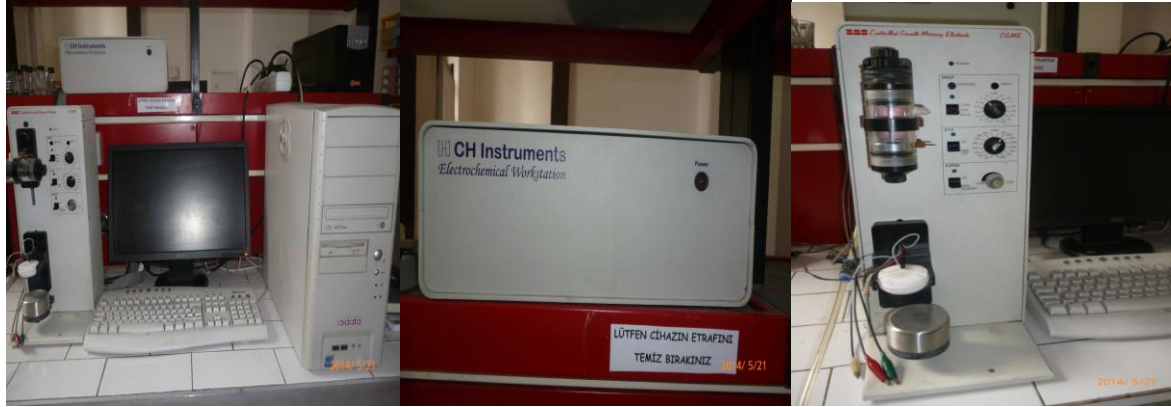
Resim 3.1. a) CHI 660 B Model Elektrokimyasal Analiz Cihazı b) CHI 660 B Model Potansiyostat Cihazı c) CHI 660 B model döner disk cıva elektrodu (CGME)
