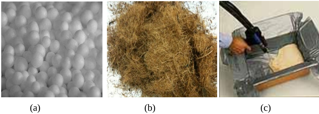
Resim 5.1. Çalışmada kullanılan adsorbanlar, (a) Strafor, (b) Çay lifi, (c) Polistiren köpük
