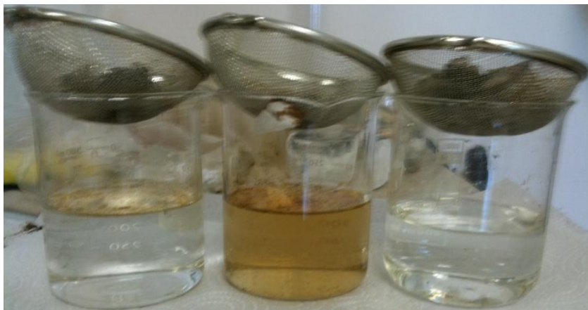
Resim 6.3. Kısa sreli (short) test sonucu; Adıyaman petrolnn szme suları
