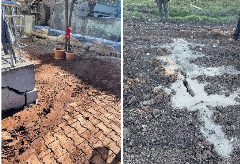
Resim 3.3. Gölbaşı'nda gözlenen zemin fişkırması (ODTÜ, 2023)
