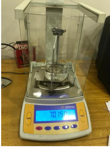
Resim 3.4. Sartorius marka yoğunluk ölçüm terazisi
