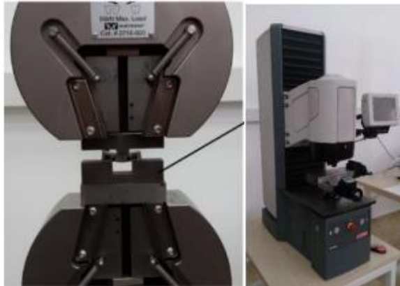
Resim 3.7. a) Çapraz kırılma test düzeneği b) Brinell sertlik ölçüm cihazı
