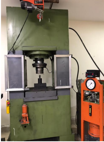
Resim 3.1. Tek yönlü pres cihazı içerisinde numunelerin preslenmesi
