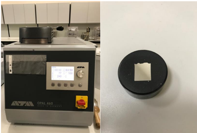
Resim 3.5. Bakalit cihazı ve Numunelerin bakalit alınmış hali
