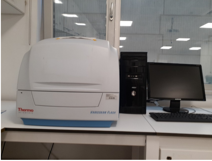
Resim 3.1. Spektrofotometre cihazı (Varioscan flash, Thermo Scientific, MA, ABD)
