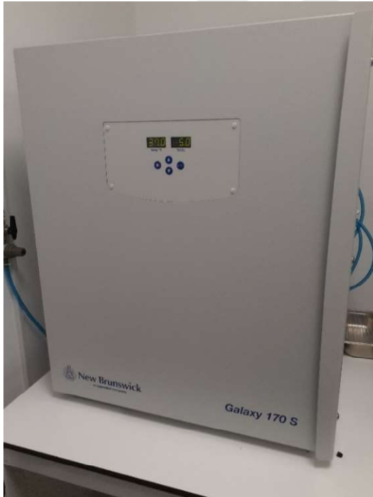
Resim 3.9. Çalışma süresince hücrelerin içerisinde bekletildiği CO 2 etüv cihazı (Galaxy 170S, New Brunswick, Eppendorf Inc., Connecticut, ABD)
