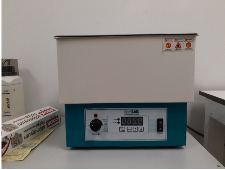
Resim 3.5. Su banyosu cihazı (Isolab banyo, ISOLAB GmbH, Eschau, Almanya)
