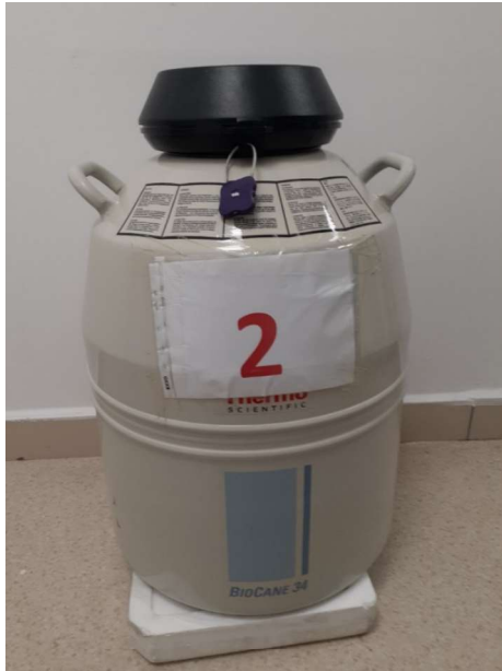
Resim 3.4. Elde edilen hücrelerin çalışma başlayıncaya kadar bekletildiği sıvı azot tankı (Biocane 34, Thermo Scientific, Massachusetts, ABD)
