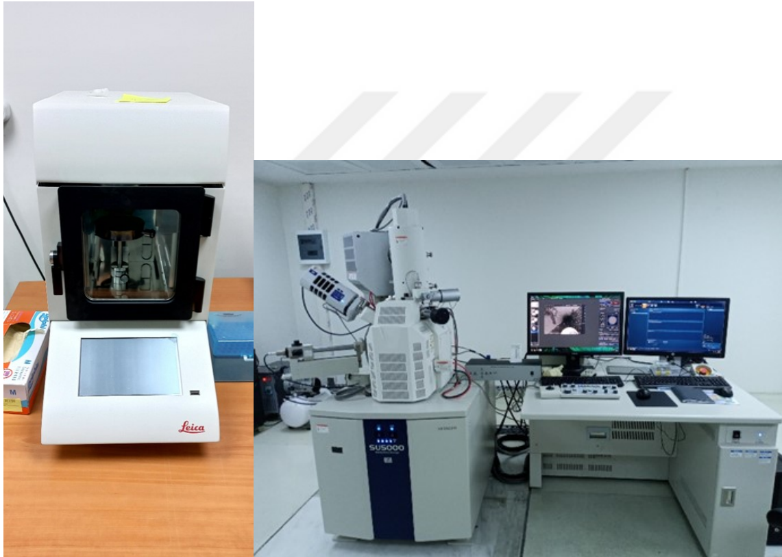
Resim 3.16. Vakum kaplama cihazı (Leica EM ACE200, Leica Microsystems GmbH, Wetzlar, Almanya) ve SEM görüntüleme cihazı (Hitachi SU5000, Hitachi High Technologies Corp., Tokyo, Japonya)
