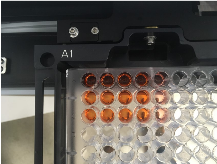
Resim 3.2.Flasklarda spektrofotometre cihazına yerleştirmek üzere hazırlanmış olan farklı konsantrasyonlardaki jelatin+MPP3 karışımları
