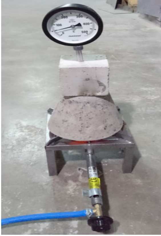
Resim 3.7. Betonun sıcaklığını ölçme denemesi
