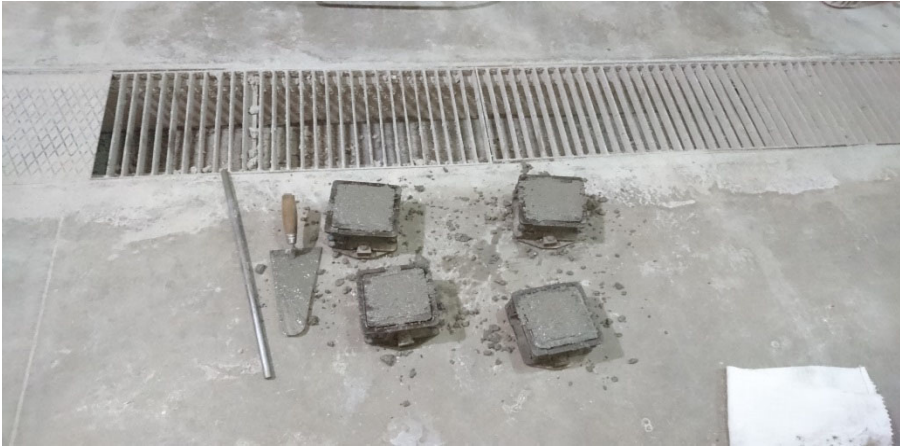
Resim 3.3. Mikserdeki betonun metal kalıplara yerleştirilmesi
