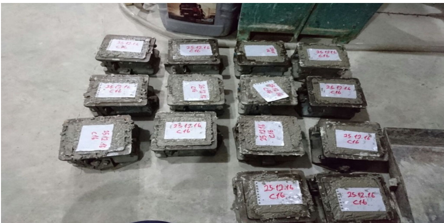
Resim 3.4. Betonun kalıplara yerleştirilmiş hali
