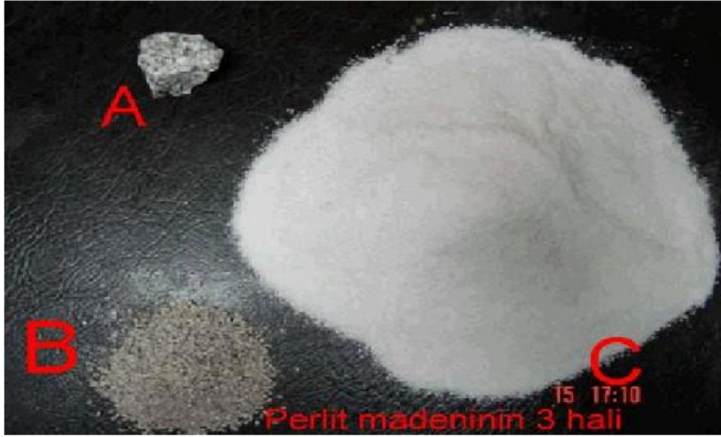
Resim 2.2. Kayaç halindeki Perlit (A), ham perlit (B), Genleştirilmiş Perlit (C)
