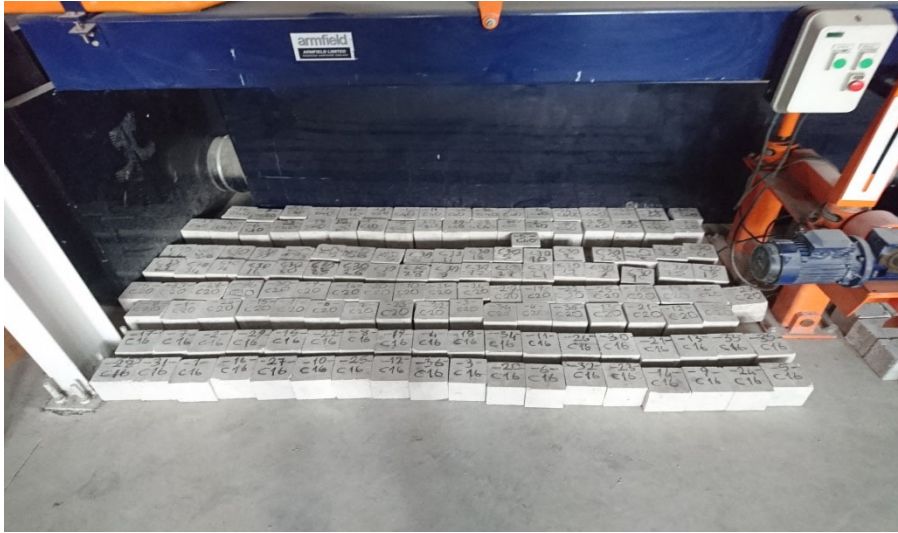
Resim 3.6. 28 günde bazı numunelerin kür havuzundan çıkarılmaları
