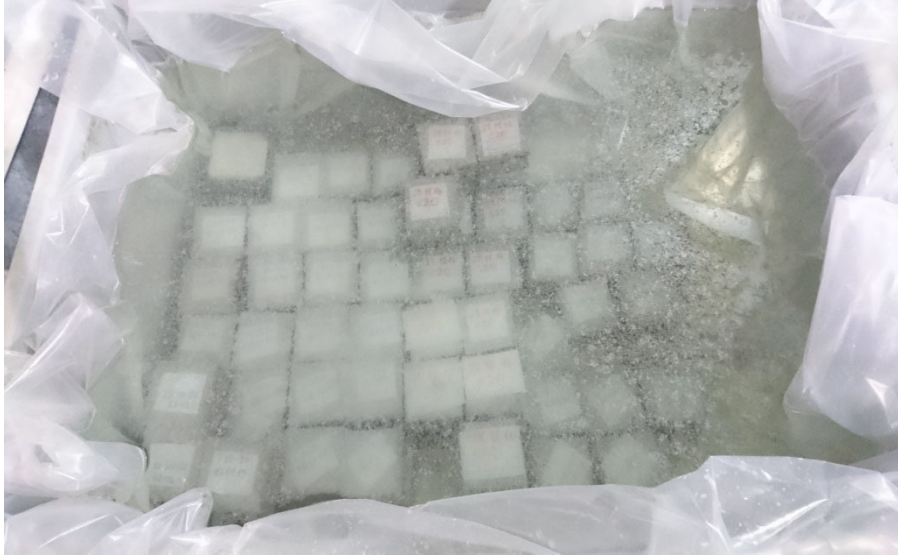
Resim 3.5. Numunelerin kür havuzunda bekletilmesi
