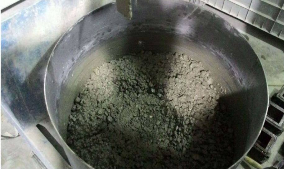
Resim 3.2. Beton karışımının mikserde karışmış hali
