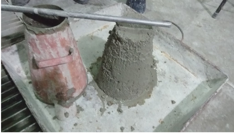
Resim 3.1. Numune gruplarının dökülmeden önce slump deneylerinin yapılması
