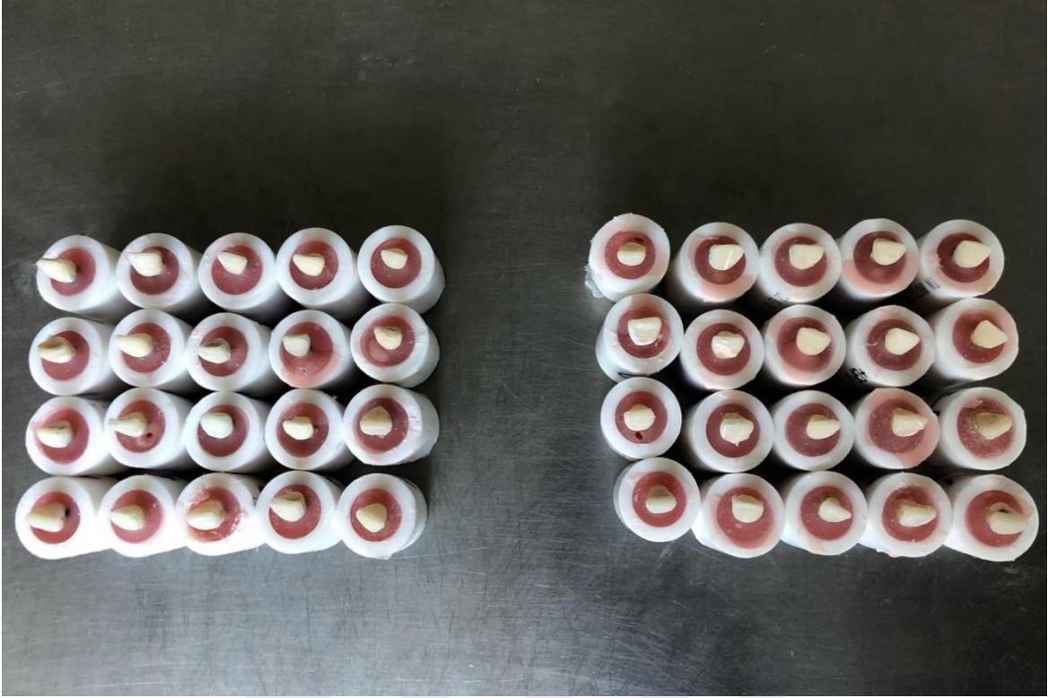
Resim 3.24. Dişlerin otopolimerizan akriliğin içine yerleştirilmesi
