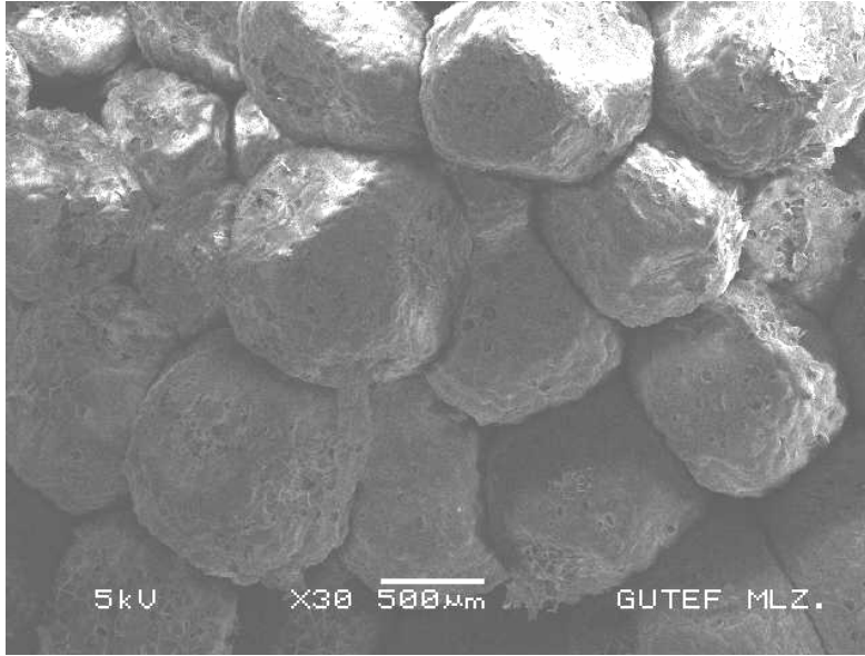
Resim 4.36. D-60-1,0-40 numunesinin çekme kırık yüzey tarama elektron mikroskobu görüntüsü
