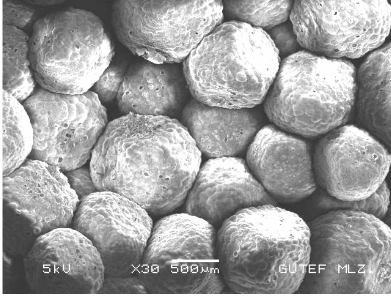
Resim 4.40. D-60-1,2-20 numunesinin çekme kırık yüzey tarama elektron mikroskobu görüntüsü
