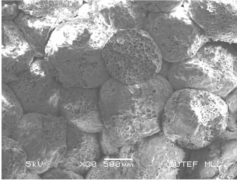
Resim 4.41. D-60-1,2-30 numunesinin çekme kırık yüzey tarama elektron mikroskobu görüntüsü
