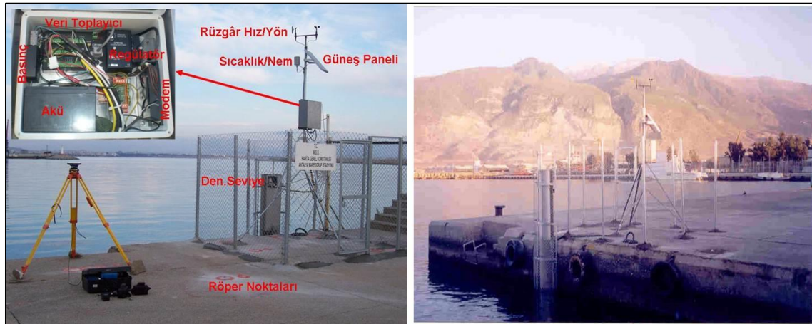
Şekil 2.2. Mareograf istasyonu ölçüm aletleri [6]
