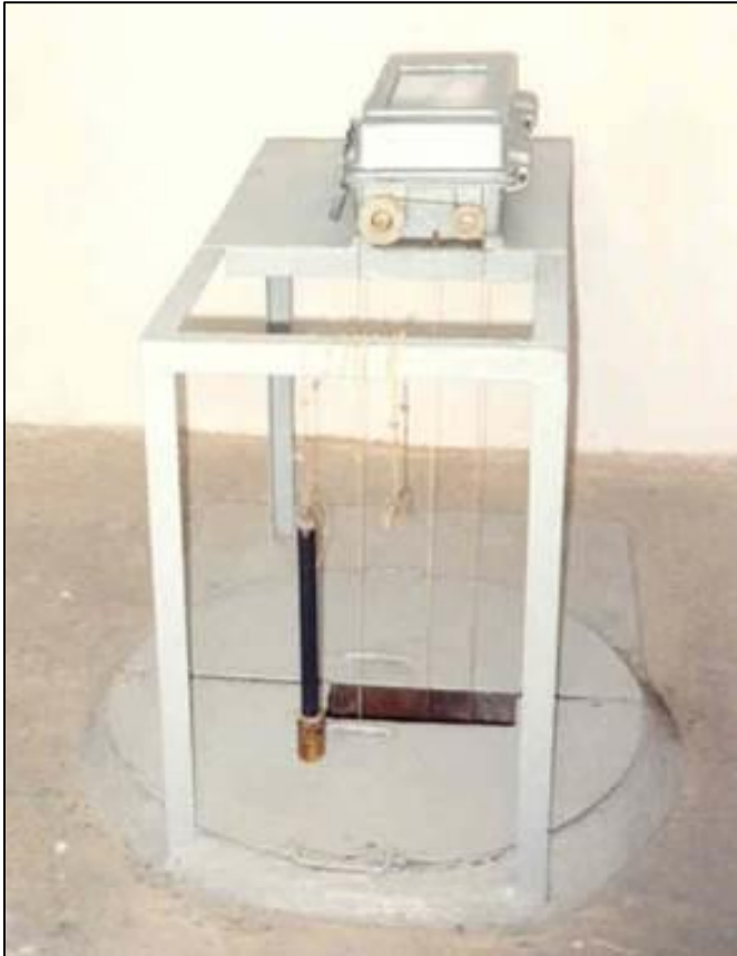
Şekil 2.4. Eski mareograf istasyonlarında iki kuyulu yatık tipte grafik kayıt cihazları [6]
