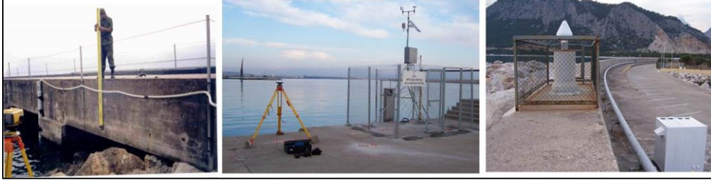
Şekil 2.3. Mareograf istasyonunda jeodezik ölçümler [6]
