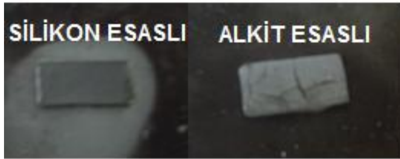
Resim 5.3. 500°C'de boyaların sıcaklık dayanımı
