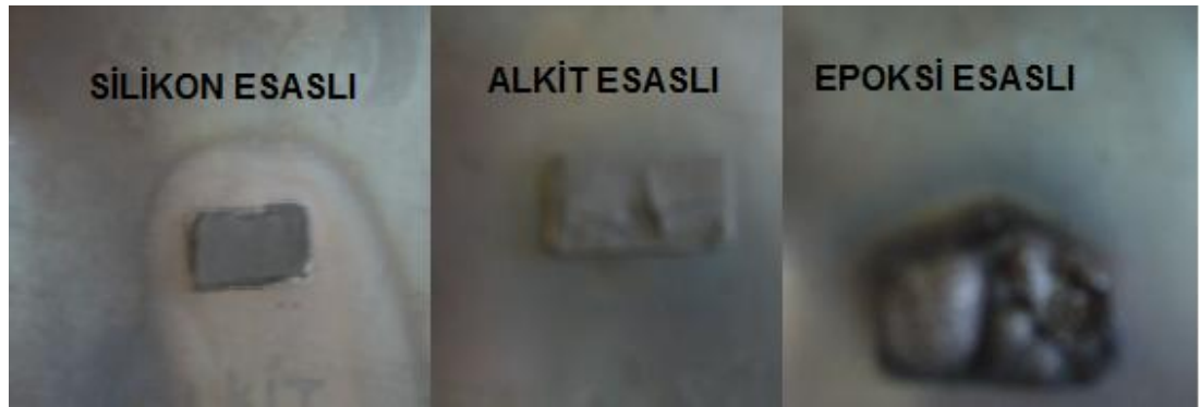
Resim 5.2. 350°C'de boyaların sıcaklık dayanımı
