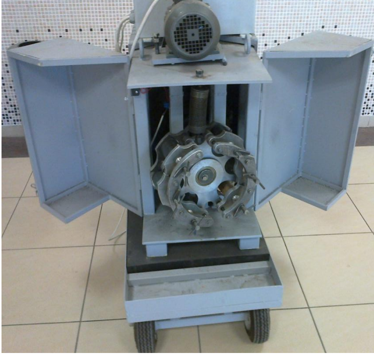
Resim 4.1. Çok tutuculu yüksek enerji çarpımlı öğütücünün fotoğrafı [Aktaş, 2013]
