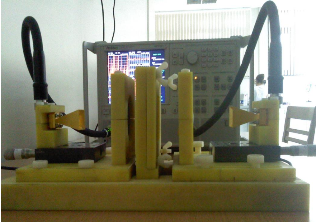
Resim 4.3. Boşluk uzay yöntemiyle absorpsiyon kapasitesi ölçümü
