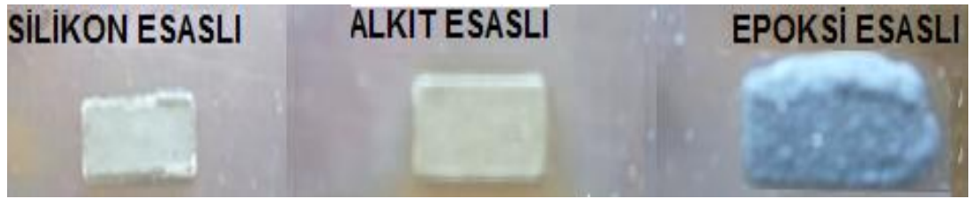
Resim 5.1. 250°C'de boyaların sıcaklık dayanımı
