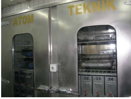
Kür dolabının dış görünüşü
