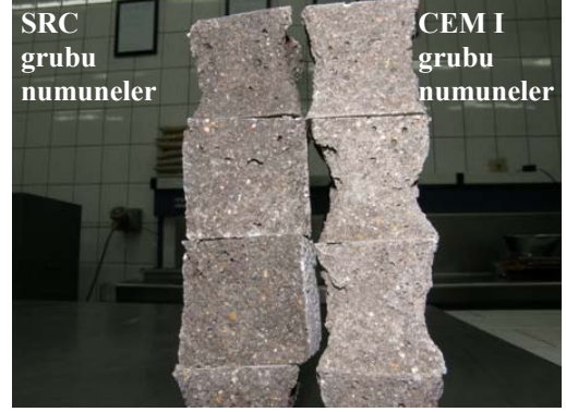
Harçların kırılma şekilleri
