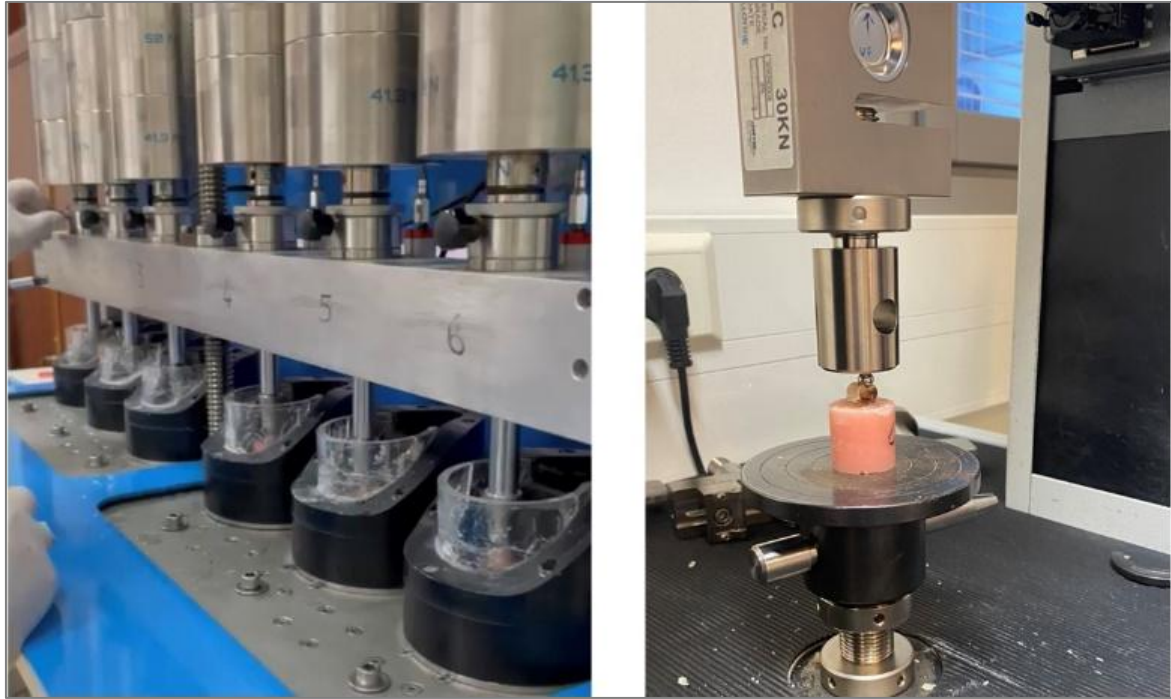
Resim 3.8. Çiğneme simülasyonu ve kırılma dayanım testi uygulanması
