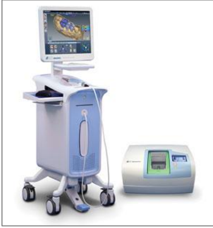
Resim 2.1. Chair-side sistem: Planmeca E4D
