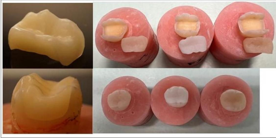
Resim 3.6. Üretilen inley restorasyonlar ve simantasyon sonrası hazırlanan örnekler
