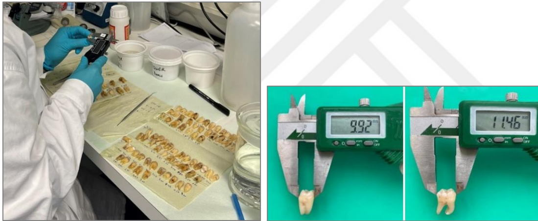
Resim 3.1. Toplanan dişlerin dezenfeksiyon prosedürlerinden sonra bukkolingual ve meziodistal boyutlarının ölçülmesi ve gruplara dağıtılması
