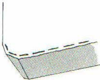
Şekil 3.13. Mekanik yorulmadan kaynaklanan kırılmalar [36]
