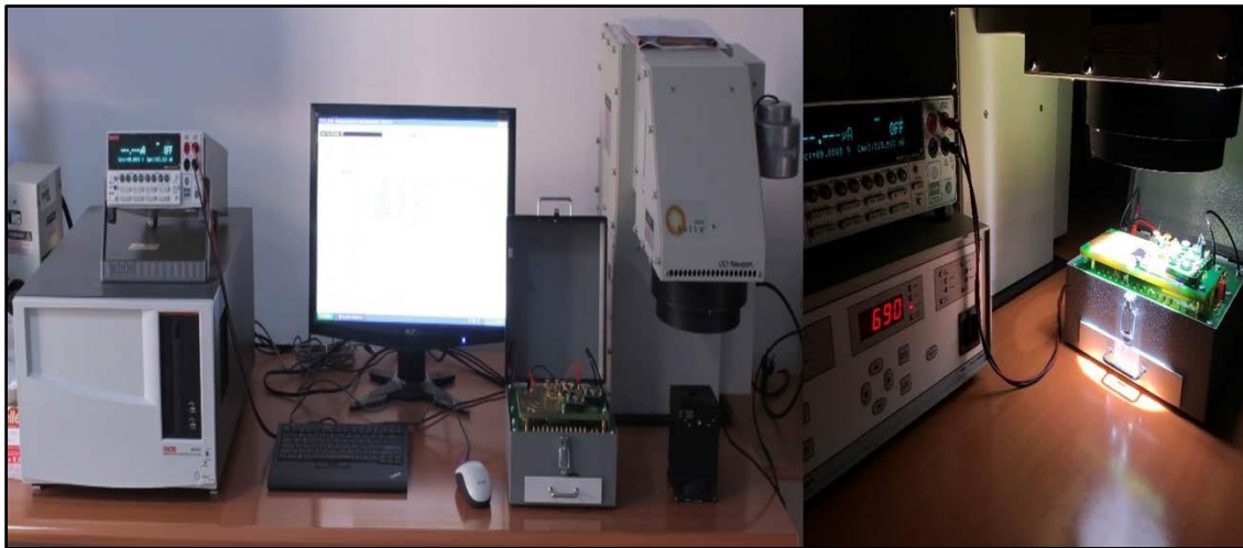
Resim 3.15. Keithley 4200 SCS I-V sistemi
