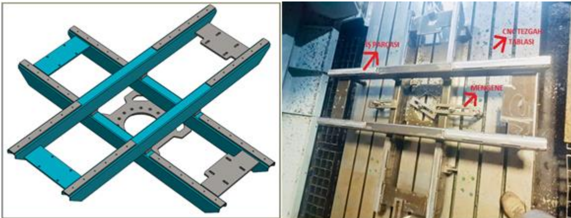
Resim 5.3. Toplama robotunun çenesinin CNC tezgâhında işlenirken bir resmi
