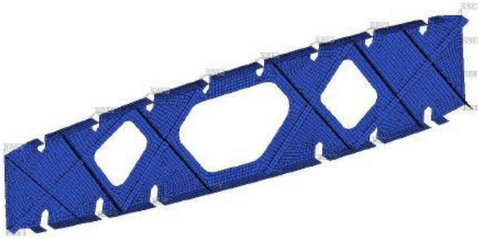
Resim 2.29. Kanat kirişinin optimizasyon sonrası yapısı [19]
