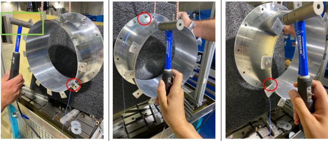
Resim 6.8. Parça 6 çekiç vurma yeri ve ivme ölçer bağlama noktaları
