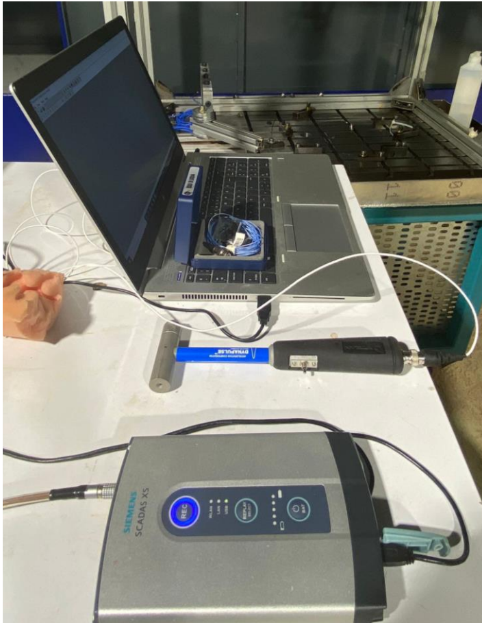
Resim 6.1. Çekiç testinde kullanılan materyaller
