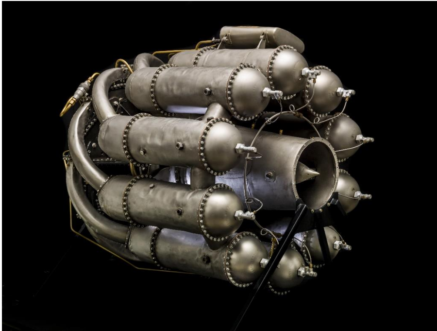
Şekil 2.2. Whittle turbojet motoru [4]
