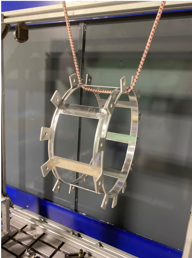
Resim 6.6. Parça-2 serbest bağlantılı test görseli
