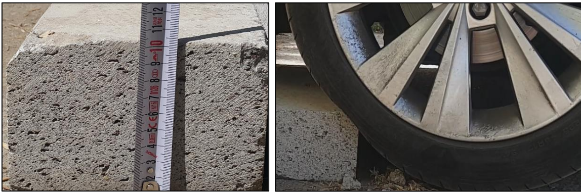
Resim 4.2. Beton engelleyici çarpma deneyi
