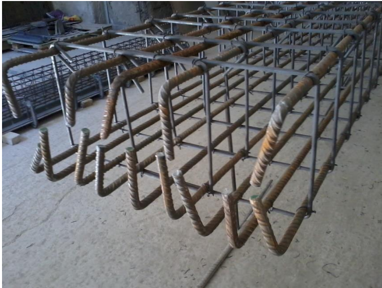
Resim 2.2. Referans deney elemanlarının donatı ve etriye detayı
