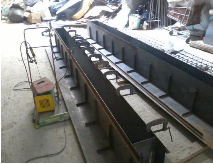
Resim 2.1. Referans deney elemanlarının kalıpları
