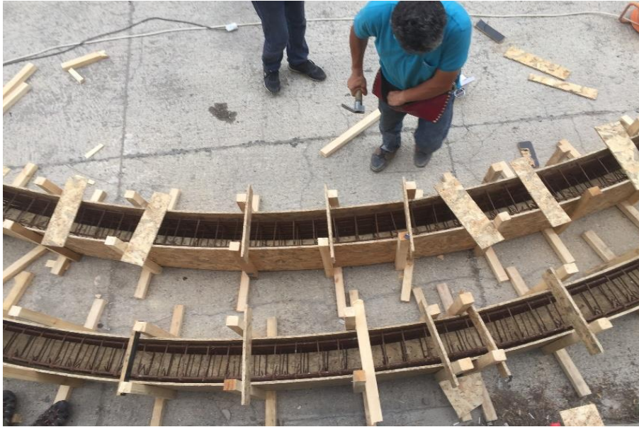
Resim 2.4. Eğri eksenli deney elemanlarının kalıp ve donatı görünümü
