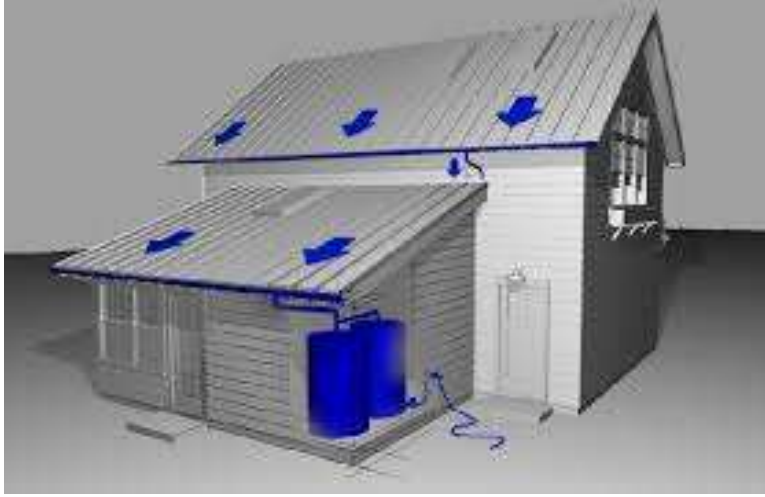
Şekil 2.22. Yağmur suyu toplama sistemi (URL-24).
