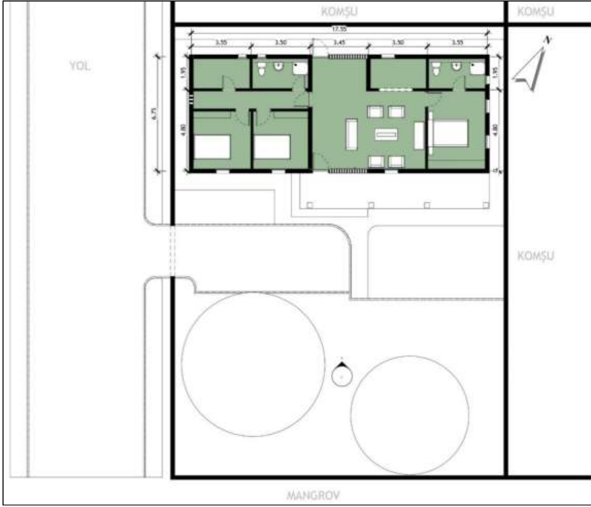
Şekil 4.4. Birinci aşamanın zemin kat planı
