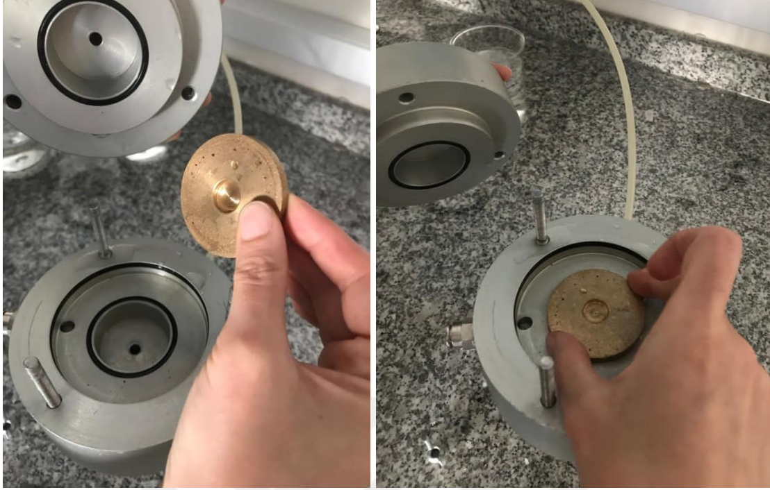
Resim 3.12. Taşın permeabilite cihazına yerleştirilmesi
