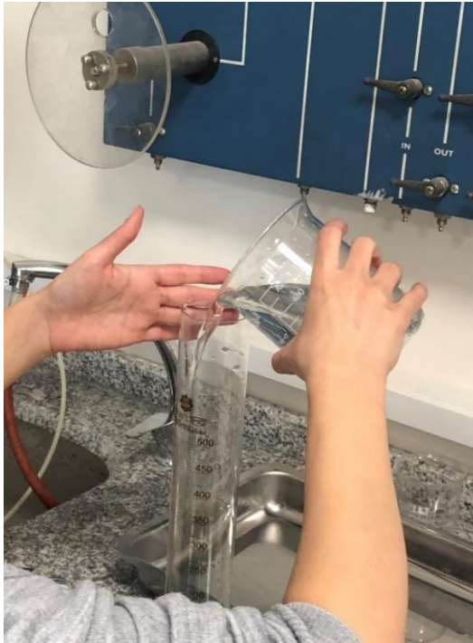
Resim 3.18. Mezür yardımıyla toplanan suyun miktarının ölçülmesi
