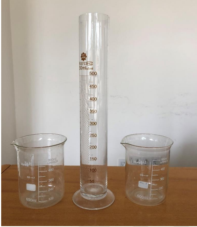
Resim 3.7. Su basıncının ölçülmesinde kullanılan beherler ve mezür
