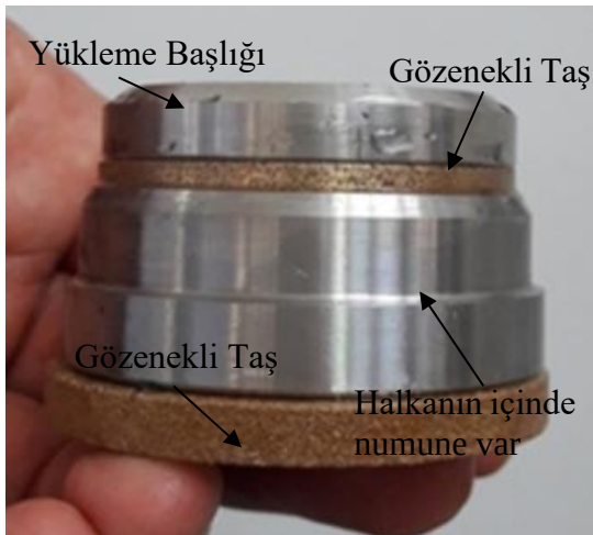
Resim 1.3. Konsolidasyon deneyinde gözenekli taşların yerleştirilmesi
