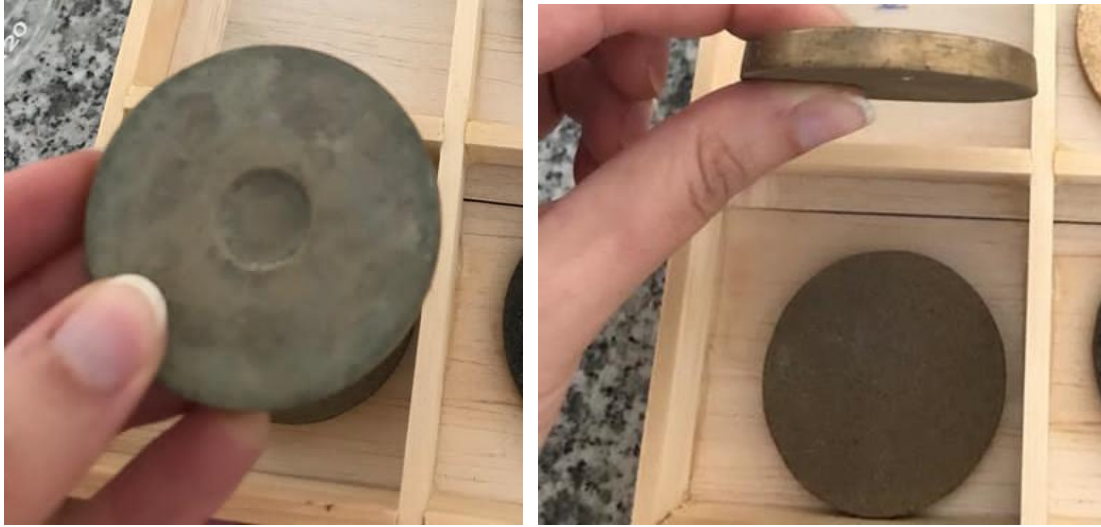
Resim 3.2. Sadece gövdeden drenaja izin veren gözenekli taş (Taşın kenarları sırlanmış olduğu için su geçirmiyor.)
