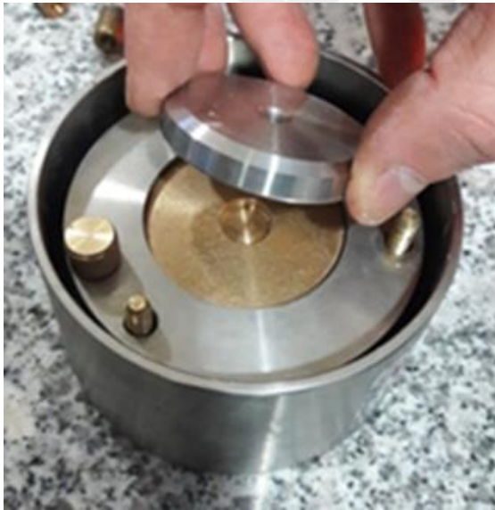
Resim 1.4. Numunenin konsolidasyon hücresine yerleştirilmesi
