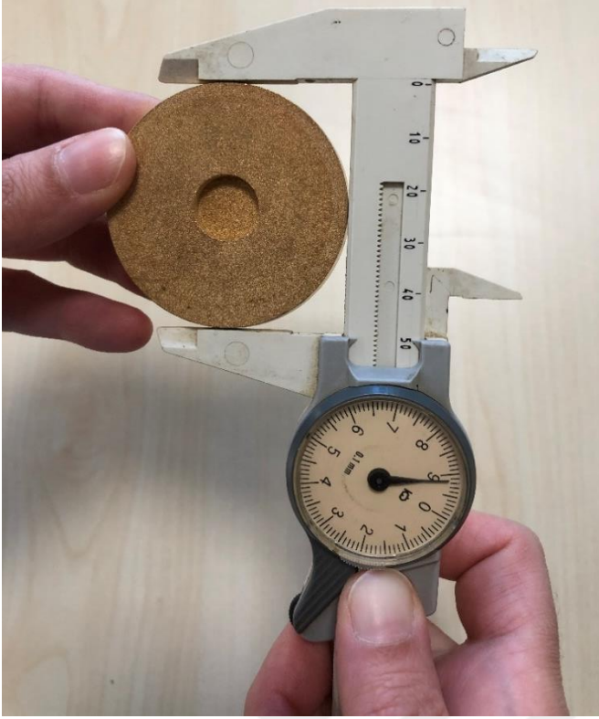
Resim 3.8. Taşın çapının ölçülmesi (Kadran 49,2 mm'yi göstermektedir)
