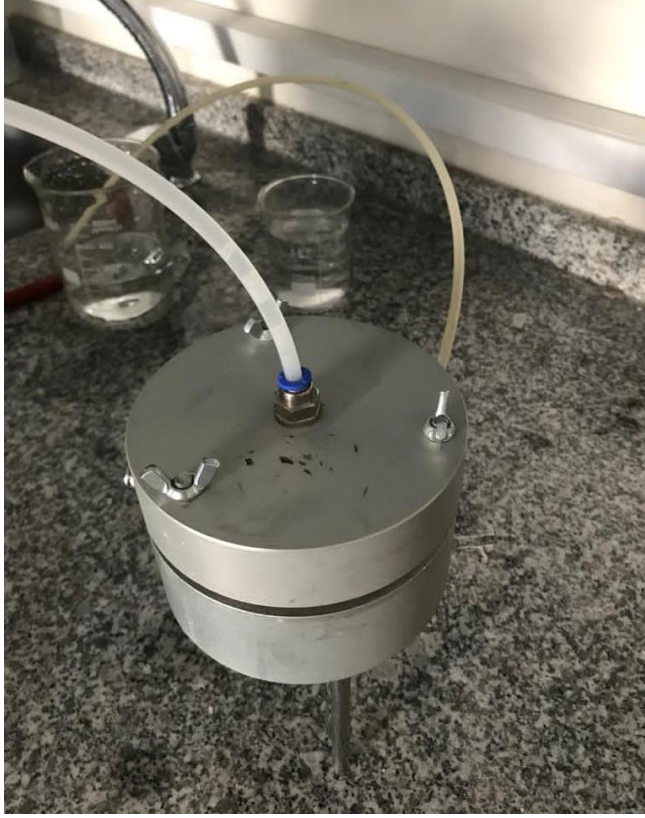
Resim 3.14. Permeabilite cihazına su giriş hortumunun takılması
