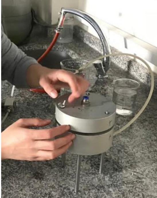
Resim 3.13. Üst başlığın yerleştirilmesi ve kelebek somunların sıkılması
