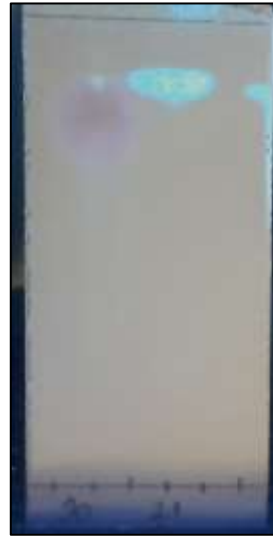
Resim 3.29. İzole edilen ve çöken bileşiklerin UV 366 'daki İTK profili
