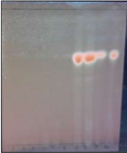
Resim 3.28. (3-6) fraksiyonuna ait Sefadeks LH-20 uygulanması ile elde edilen alt fraksiyonların revelatör püskürtüldükten sonraki UV 366 görünümü
