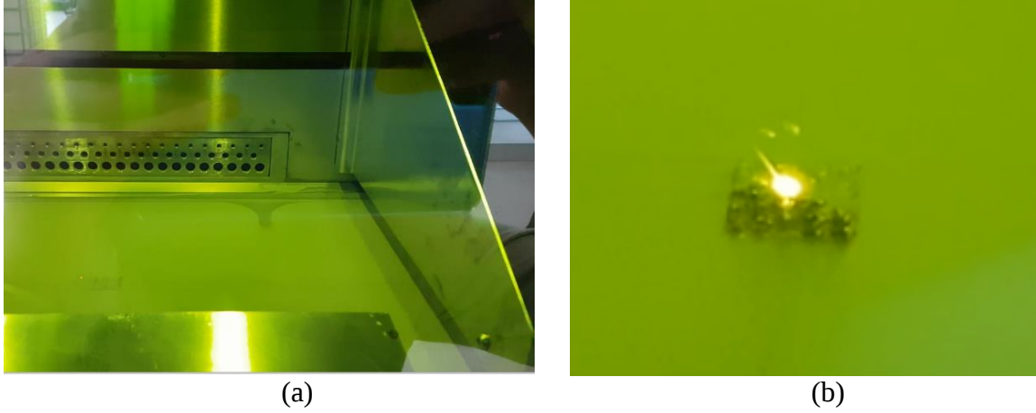
Resim 4.3. Üretim haznesi (a) ve S3 numunesinin lazerle taranması (b)
