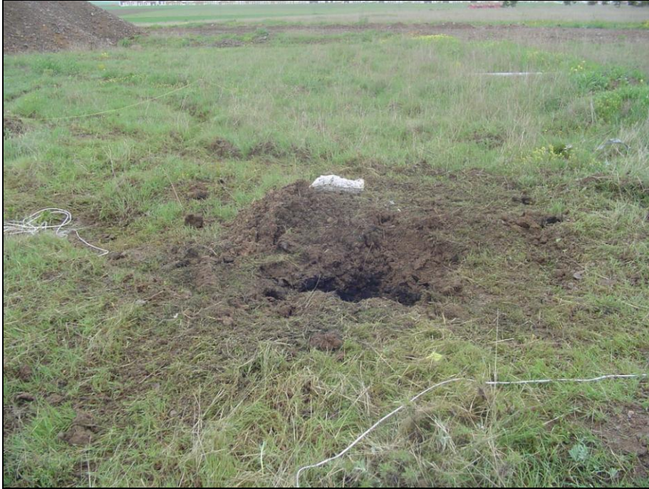
Resim 4.6. Derin patlatma ardından patlatma noktası yüzeyindeki zeminde oluşan plastik deformasyonlar (SK 7)
