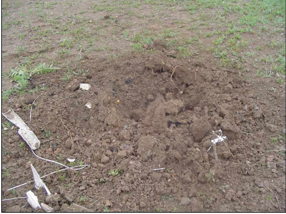
Resim 4.5. Derindeki patlatma ardından yüzeydeki zeminde oluşan plastik deformasyonlar (SK 6)
