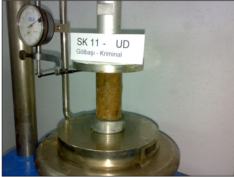
Resim 3.18. Numunelere uygulanan serbest (tek eksenli) basınç deneyleri (SK – 11)
