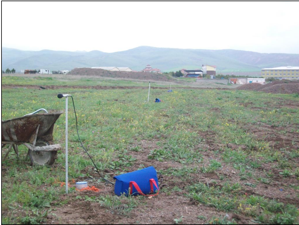
Resim 4.1. Patlatma öncesi güneydoğu yönünde (yeni yapılaşma düşünülen alan yönünde) titreşim ölçer aletlerin yerleşimi
