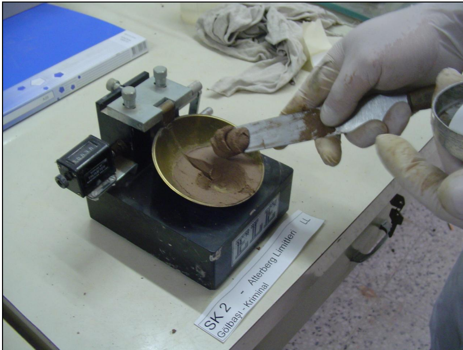
Resim 3.13. Likit limit tayini deneyi uygulama sonrası su muhtevası tespiti için numune alımı (SK 2 numunesi)
