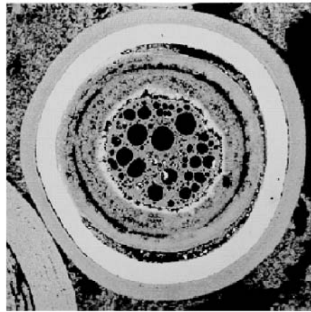
Şekil 3.8. TRISO kaplamalı parçacığın kullanılmadan önceki ve kullanıldıktan sonraki hali [53]
